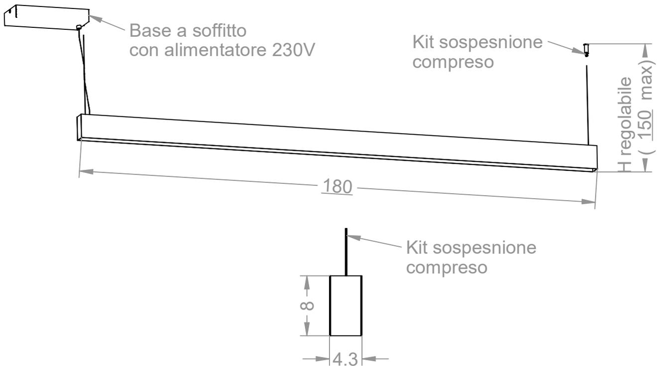
Sospensione con struttura in metallo verniciato bronzo satinato, illuminazione tramite doppia linea di luce LED up-down. Disponibile luce calda 3000°K o natural 4000°K
