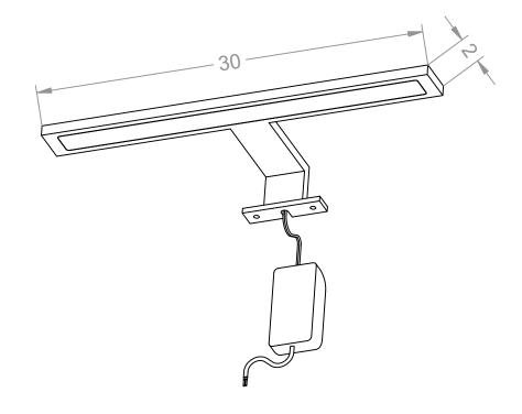
Lampada per specchiere con attacco a telaio, struttura in metallo finitura cromo scatola da 20pezzi
